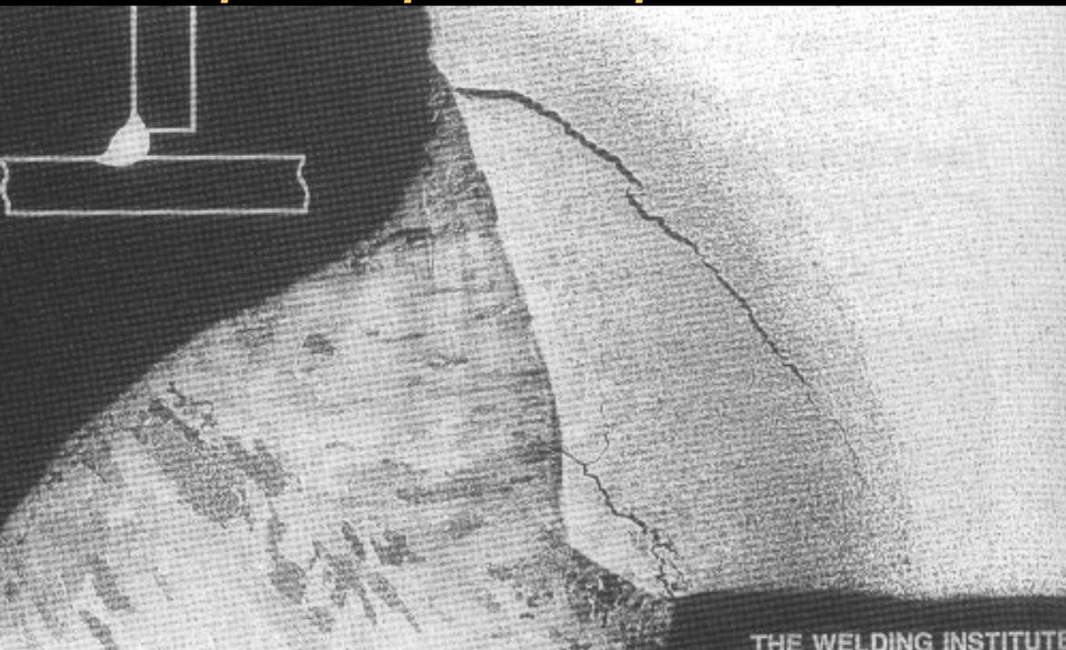
Трещина, образовавшаяся под воздействием напряжений уголка, сваренного с помощью защитного электрода
